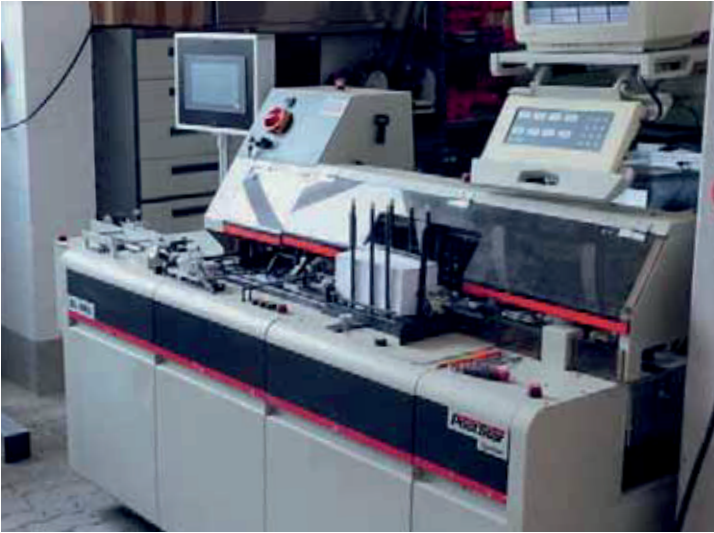
Beispiel: eine Kuvertieranlage mit von Twin-K nachgerüstetem Lesesystem.
