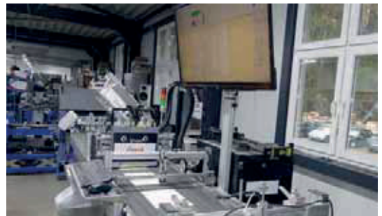
In der ersten Station wird die Seite bedruckt, die Personalisierung gelesen und der zweite Drucker angesteuert.
